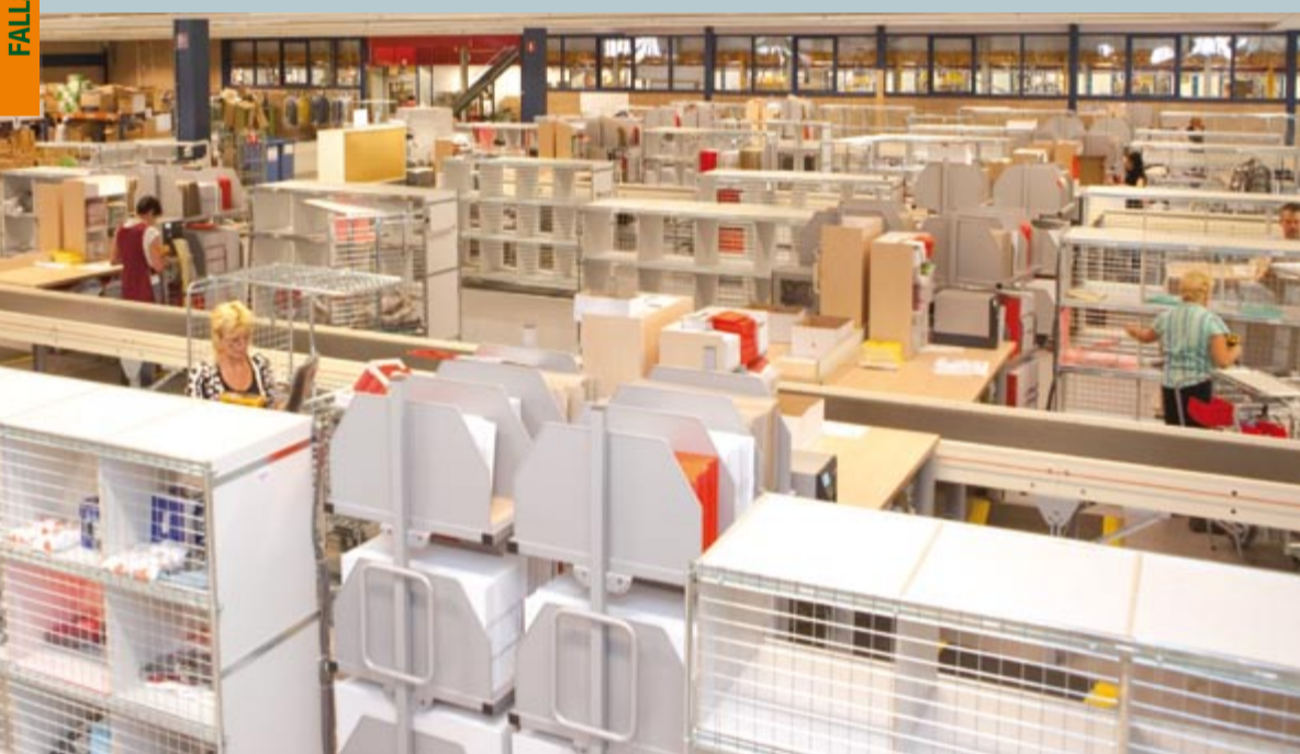
Smart und manuell: Die Kommissionierung erfolgt wesentlich schneller, da alle Warenentnahmen in einem Zug erfolgen. Das gleiche gilt für die Sortierung, die auftragsrein in einem Arbeitsgang vorgenommen wird. Beides zusammen führt in Verbindung mit der lichtgesteuerten Artikelverteilung zu einer spürbar beschleunigten sowie praktisch fehlerfreien Abwicklung der Aufträge.
