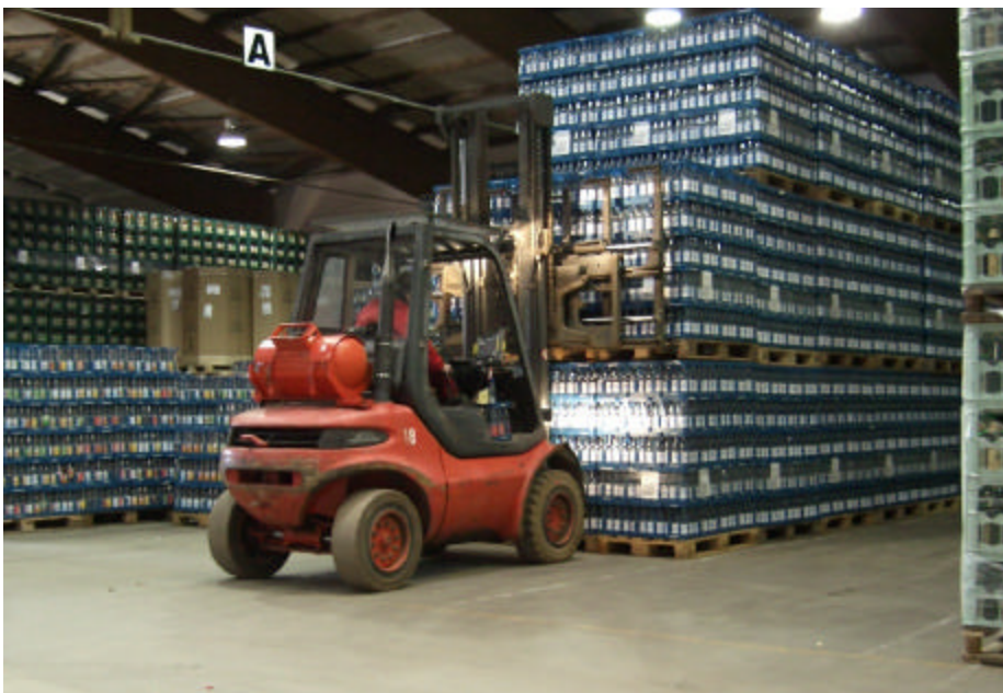
Durchschnittlich vier Verladestapler - je zwei Zweifach und zwei Dreifachstapler - werden im Förstina-Lager zur Ein- und Auslagerung sowie zur Nachschubsteuerung eingesetzt
